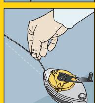
KROK 3 Po vytiahnutí do požadovanej dĺžky zaklapnutím kľúčky do puzdra zablokujete odvijanie šnúry.
